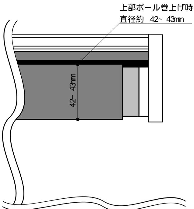
図1 天井取付時サイズ別外形寸法
